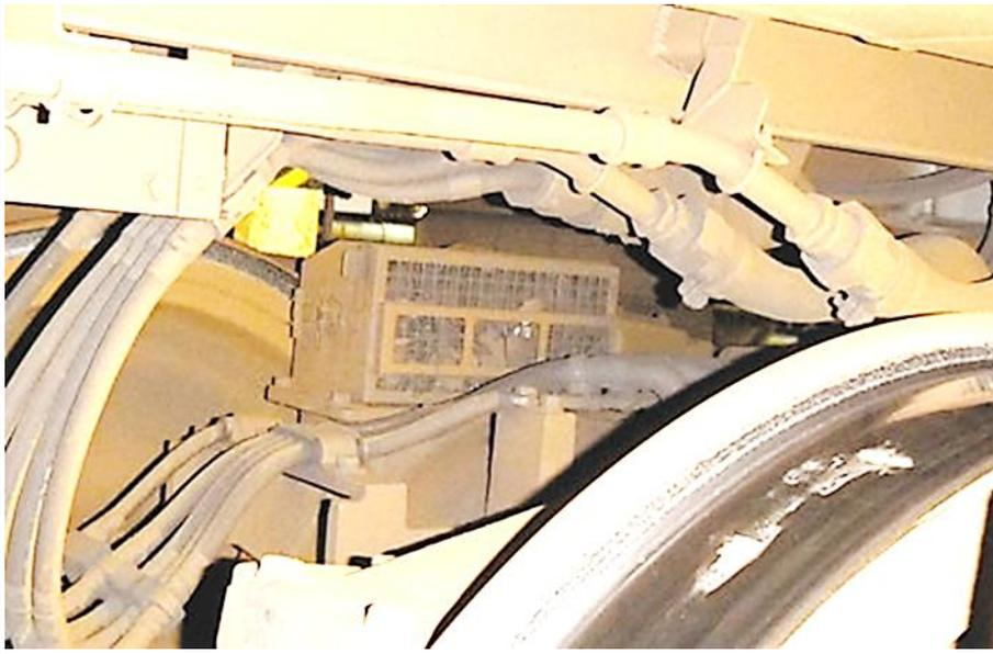
組合が調査した試運転の車両は1月18～22日の5日間運行。車輪付近にはモーターなどの空冷装置にフィルター（◀左の写真奥）が取り付けられている。外気を取り込む際にちりなどを除去するためだ。
